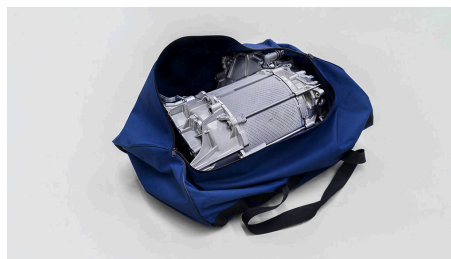
Silnik elektryczny Volkswagena ID.3 – tak kompaktowy, że zmieści się w sportowej torbie
