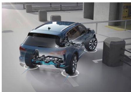
Nowy system czterech kół skrętnych w akcji, podczas manewrowania
