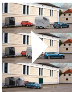
System automatycznie wykonuje ruchy kierownicą, kierowca porusza przyczepą operując pedałami gazu i hamulca
