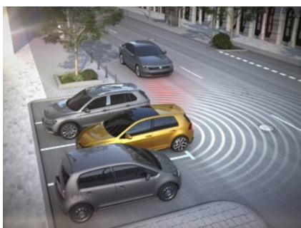
Czujniki radarowe monitorują przestrzeń z tyłu
