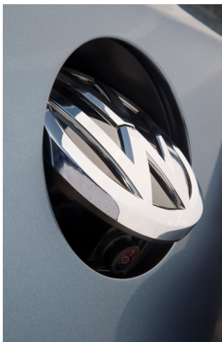
Widok z tyłu wykorzystuje tylną kamerę wbudowaną w unoszone logo
