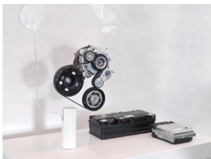
48-woltowy rozrusznik napędzany paskiem, akumulator 48V i konwerter DC/DC
