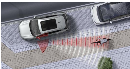
System ostrzegający pasażerów o zbliżających się z tyłu pojazdach jest standardem w ID.7, Passacie i Tiguanie.
