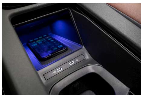
Półka na telefon z funkcją ładowania akumulatora – w ID.4 zastosowano różne rozwiązania dopasowane do różnych rynków sprzedaży
